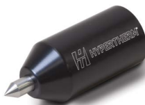
Programmeringsverktyg för brännare Programmeringsverktygen för brännare gör det möjligt för systemoperatörer att programmera skärbanan samtidigt som de kan kontrollera visuellt att brännaren inte kommer i kontakt med arbetsstycket under skärningen.
